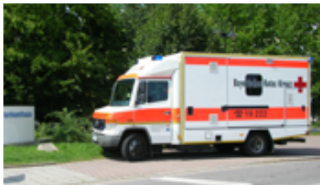
ITW der 3. Generation von 2006 bis 2013. Funkrufname: Rotkreuz Regensburg 32/60. Mercedes Benz Vario. Ausgebaut durch Fahrtec Systeme.
