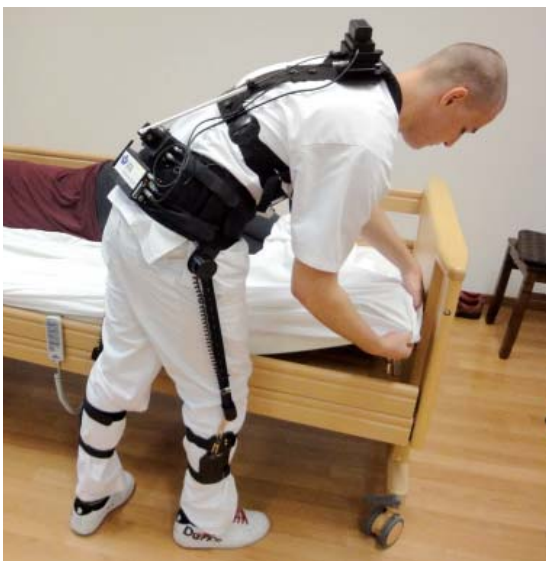
Die Pflegekraft wurde mit einem kompletten Messsystem bestückt, das alle Bewegungsabläufe aufzeichnet.
